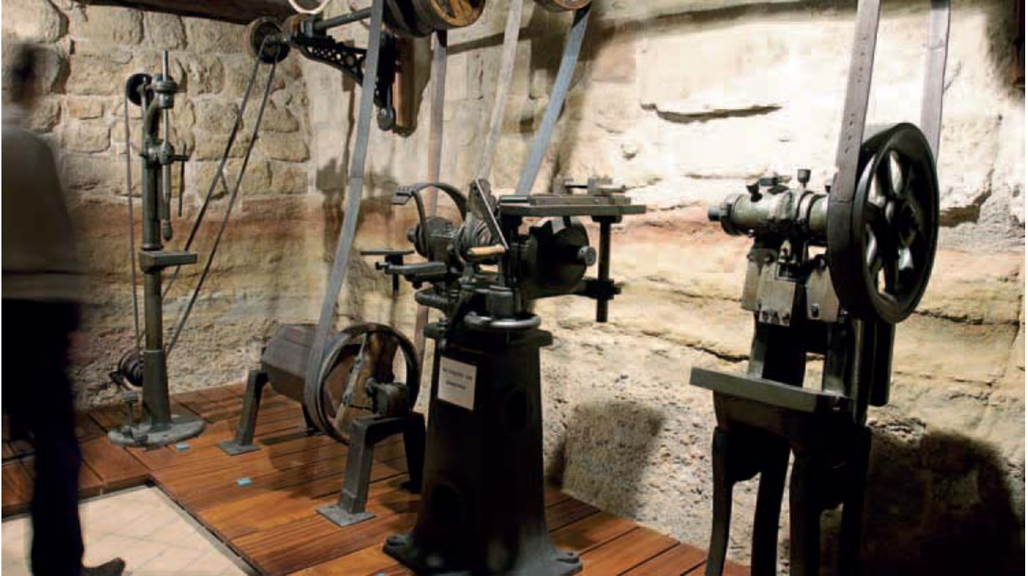
Algunes de les màquines per fabricar ganivets: la trepanadora per foradar, el bombo de polir, la màquina per esmolar i la premsa per tallar les fulles.
